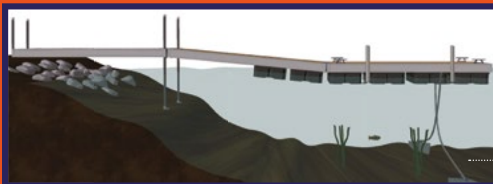
INSTALLATION TYPIQUE EN QUAI FLOTTANT
